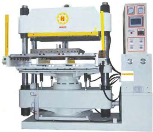
全自动平板硫化机(台面加大) Automatic platen vulcanizing machine (big plate)
